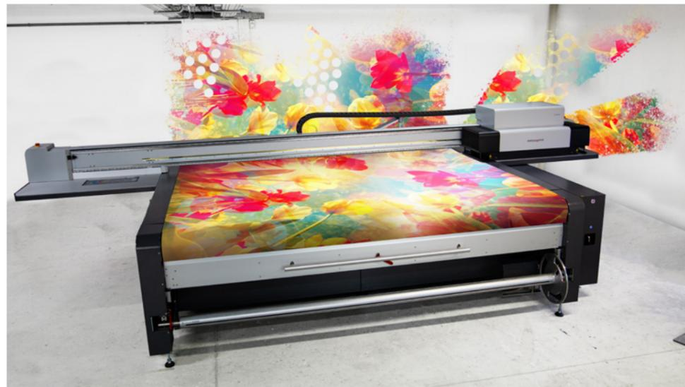
Un traceur numérique impression HD à jet d'encre UV, quasiment unique en France : l'Impala. Ce bijou de technologie est capable d'imprimer en relief ou non sur n'importe quel support, jusqu'à 50 mm d'épaisseur (PVC, aluminium, bois, verre, dibond, bâche, vinyle...), et ce jusqu'à 2,5 mètres de large et 4 mètres de long à une cadence de plus de 180 m<sup>2</sup>/heure. Avec l'Impala, les projets (PLV, ILV, enseigne...) n'ont plus aucune limite.
